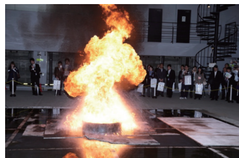
写真4 軽油の燃焼性状実験
