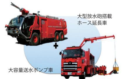
大型放水砲搭載ホース延長車 + 大容量送水ポンプ車
