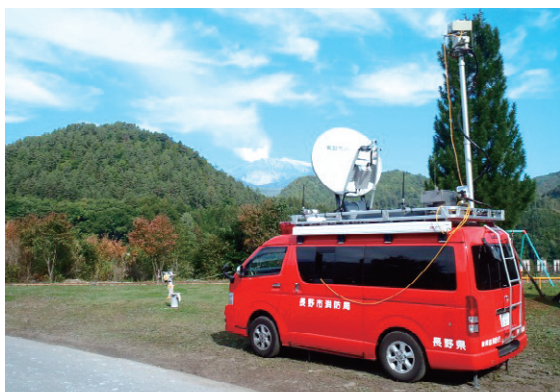
無線中継車による現地映像の送信（長野市消防局提供）
