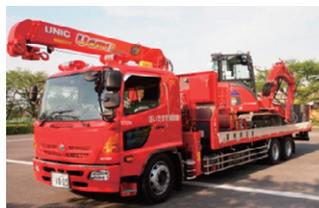
最大2.9tの吊り上げ能力クレーンを搭載し、4種類のアタッチメントを積載する。
