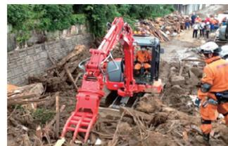
遠隔操作が可能で、大規模震災時だけでなく土砂災害時や大規模施設の残火処理活動等にも活用可能。
