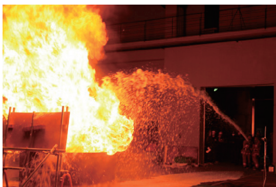
模擬タンク火災泡消火の様子
