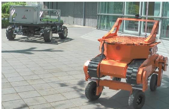
写真1 地上走行型の偵察ロボット（右）、
