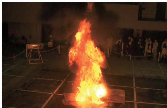
写真4 重油の燃焼性状実験
