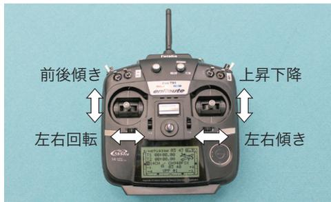
運用時は、操縦者、上空監視員、パソコン等確認者の複数の隊員で隊を編成し、操縦者はプロポのジョイスティック操作による機体の、上昇・下降、前進・後退、左右傾き、左右旋回等の操作を行い、監視員は目視による機体の安全管理、パソコン等確認者は受信した映像等の状況を確認します。
