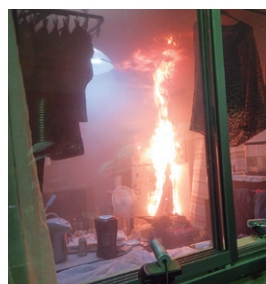
模擬家屋室内の延焼状況
