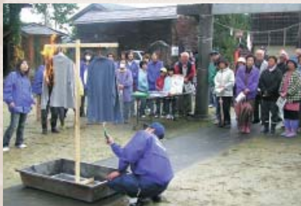
防災製品の燃焼実験の様子
