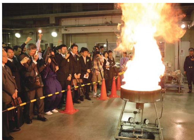
写真1 泡消火剤による小規模タンク火災の消火実験
