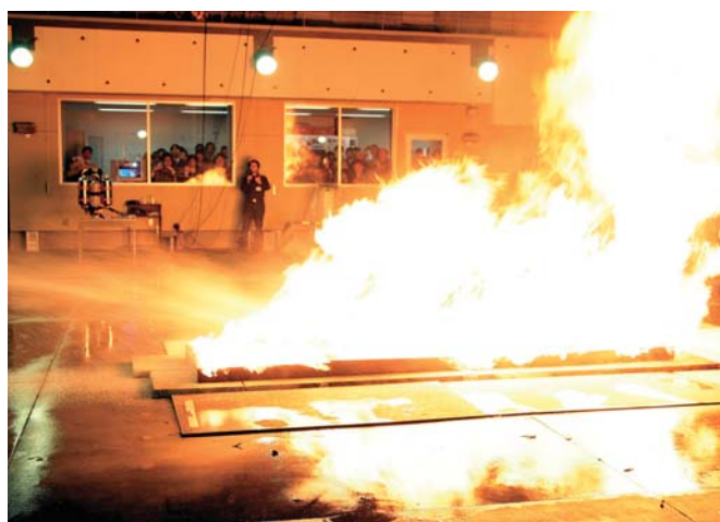
写真2 2流体ノズルを用いた可燃性液体の消火実験
