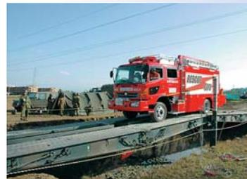
自走架柱橋設営(自衛隊)により緊急消防援助隊の進出路の確保(射水市会場)
