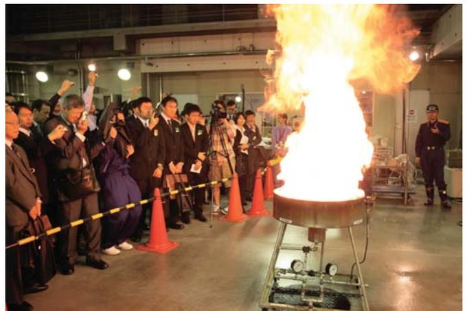
泡消火剤による小規模タンク火災の消火実演
