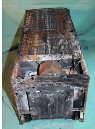
写真3 焼損した冷凍冷蔵庫背面の状況
