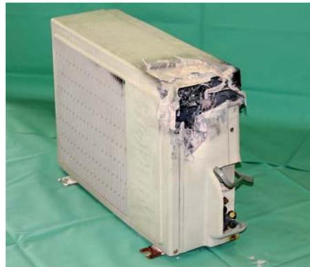
写真2 焼損したエアコン室外機の状況
