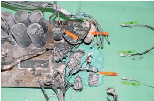
写真4 エアコン室外機の制御基板の焼損状況
