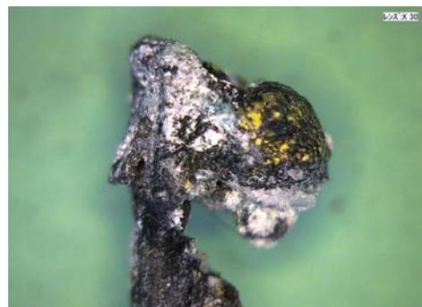
写真8 ファンモーター電源線の端子の熔融状況
