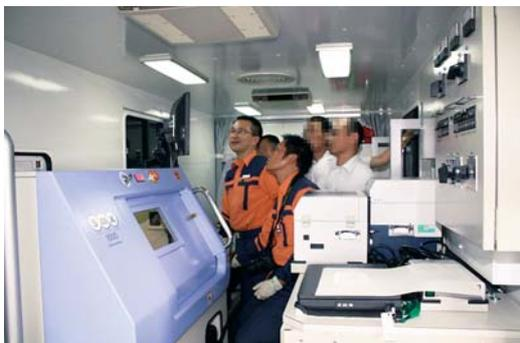
写真5 機動鑑識車に搭載されているX線透過装置
