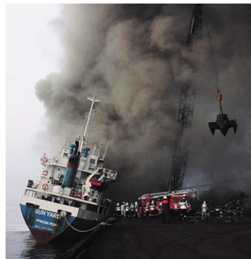
平成21年6月の貝塚市ふ頭での船舶火災 (注水のため、船が傾いています。建設重機を使って、燃烧物を移動させています。) (写真提供：貝塚市消防本部)
