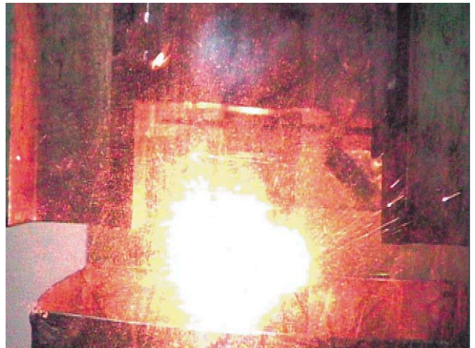
リチウム電池（未使用、コイン型）の危険性評価試験の様子 （5kgの鉄の重りを高さ0.8mから電池上に落とすと衝撃により爆発しました。リチウム電池は、電解液が（強酸化剤＋有機物）から構成されている場合があり、危険性を有していると考えられます。このような爆発は、リチウムイオン電池、アルカリ電池等の実験では観測されていません。）
