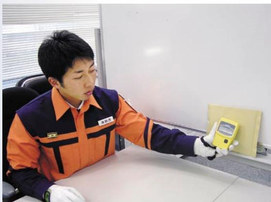
ガンマ線及びエックス線用線量率計で測定中
