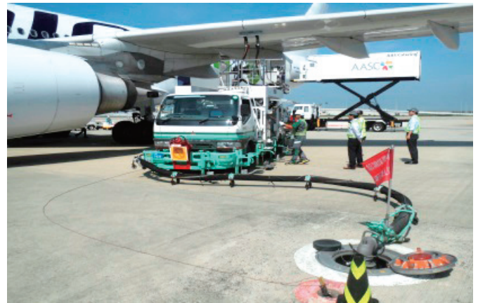
航空機給油取扱所の様子
