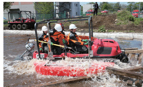
津波被害現場用の消防車両開発
