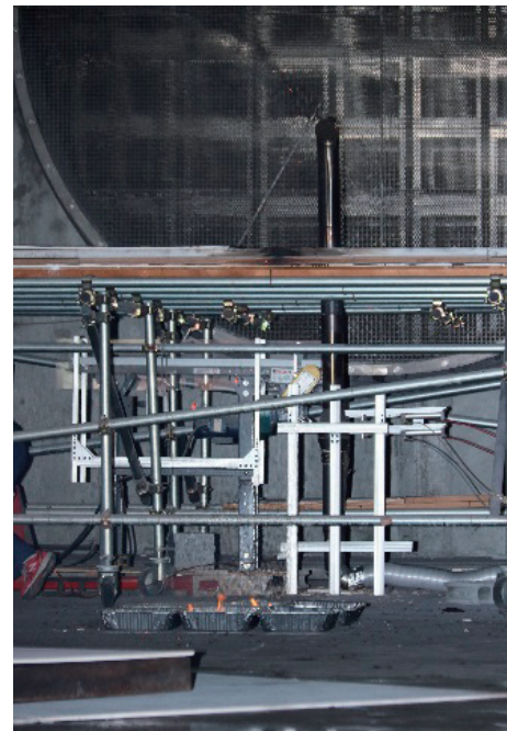
写真2 火の粉の加害性の実演 （中央上に伸びている縦のパイプが火の粉発生装置）
