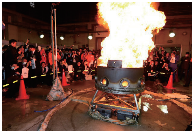
写真5 石油タンク火災の泡消火技術の実演
