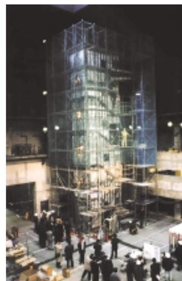
実大規模火災実験用階段室模型
