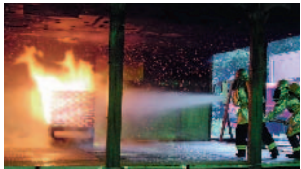
写真2 ノズル性能評価の為に準備した実験区画での消火実験
