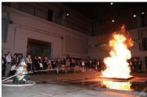
写真2 可燃性液体火災の泡消火実験
