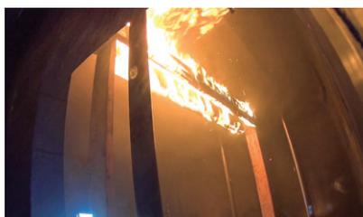
写真2 2×6材の設置状況と燃焼状況
