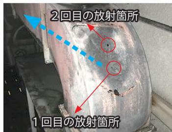
されている開口部が多数存在する場合や開口部の面積が大きい場合、火災建物の屋根が崩落している場合など、ミスト放射が火災区画に充満されない条件下においては、ウォーターカッターによる消火効果を期待することはできないと考えます。
