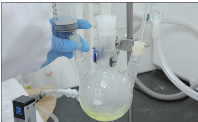
三口丸底フラスコの中で塩化水素が水に溶け込んでいる様子
