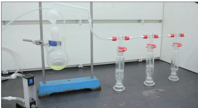
三塩化アルミニウムの水添加試験の様子 吸収瓶の中で塩化水素が発生。
