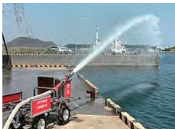
【無人放水ロボット】
