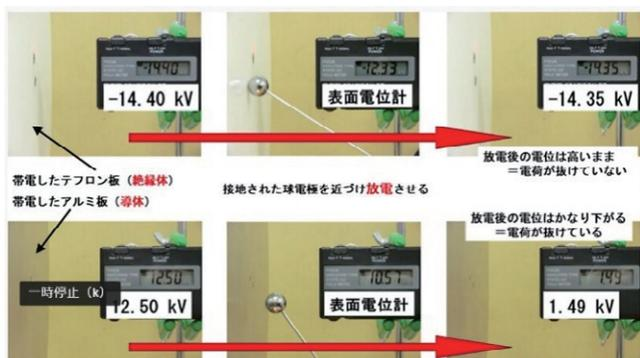
写真4 絶縁体（上段）と導体（下段）の放電前後の帯電電位の変化
