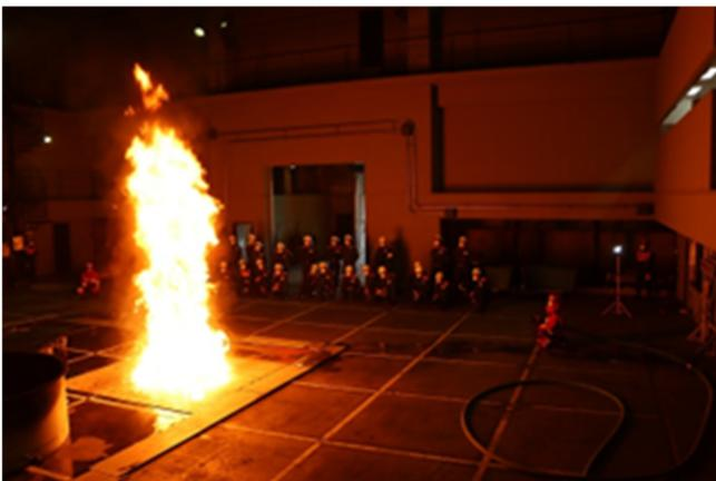
危険物科においても、危険物施設における火災性状等に関する理解を深めることを目的に、スロップオーバー現象（放水等の水分が燃焼油の表面近くの油層内で気化し油と水と一緒に溢流する）や、ボイルオーバー現象（タンク火災等で高温になった油の層が厚くなって、タンク内の水分に触れ、水が瞬間的に蒸発、燃焼油とともに爆発的に溢れ、飛び散る現象）を模擬的に再現させる燃焼の見学を実施しています。
