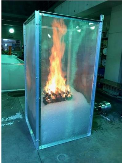
写真3 泡発泡装置を用いた消火実験
