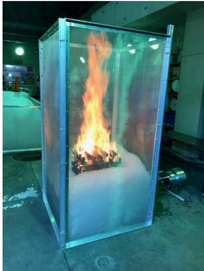
写真3 泡発泡装置を用いた消火実験
