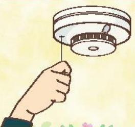
すべての住宅に設置が必要な住宅用火災警報器。故障や電池切れで万が一の時に作動しないことがないよう、定期的に作動確認し、10年を目安に交換することが大切です。
