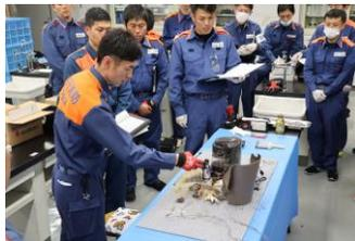
電気火災鑑識要領(電気製品の分解)
