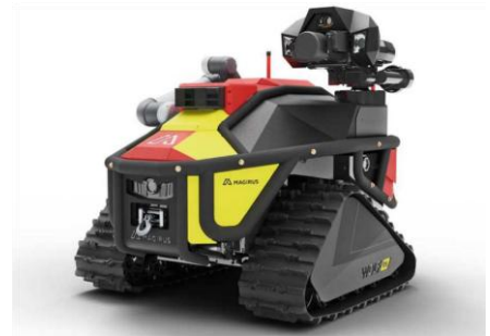
【無人走行放水ロボット】
