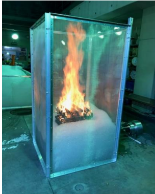
泡発泡装置を用いた消火実験 [消防研究センター]
