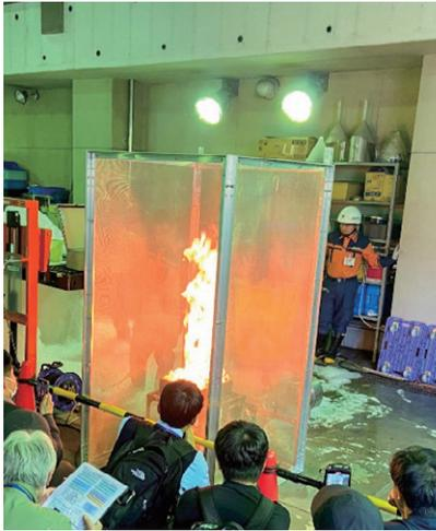
写真3 高発泡装置を用いた泡消火実験
