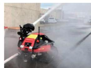
遠隔操作消火ロボット
