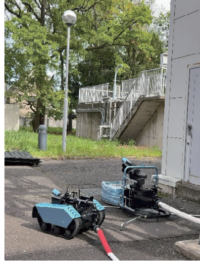
写真5 危険な現場で使用するリモコン式の無人放水車の紹介
