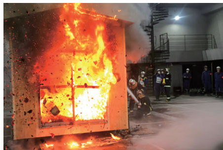
模擬家屋の消火状況
