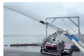
【無人走行放水ロボット】
