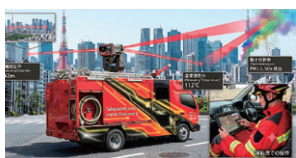
【長距離化学遠隔検知装置を搭載した高度情報集約車】
