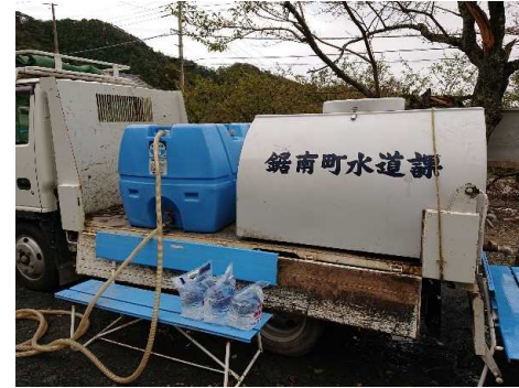
停電による水圧不足からの応急給水活動
