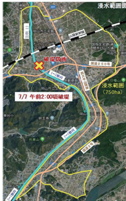
【砂川破堤による浸水範囲】
