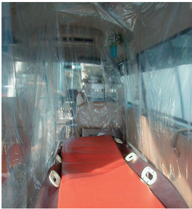
患者収容部分を分画した例（内部）
