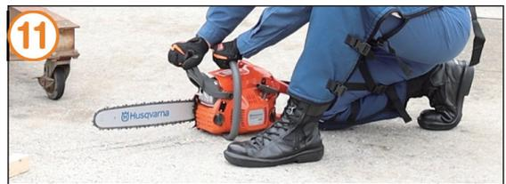
⑫スターターロープの切断防止のため、スターターロープを少し引き出した状態でエンジンを停止します。
