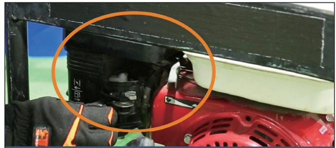
燃料コック、チョーク、スロットル調整レバーの点検
