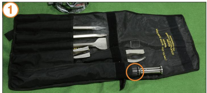
②目的に応じた先端工具を選択します。本体先端部にあるリティナーロックリングを緩め、先端工具を先端部にしっかりと差し込みます。
