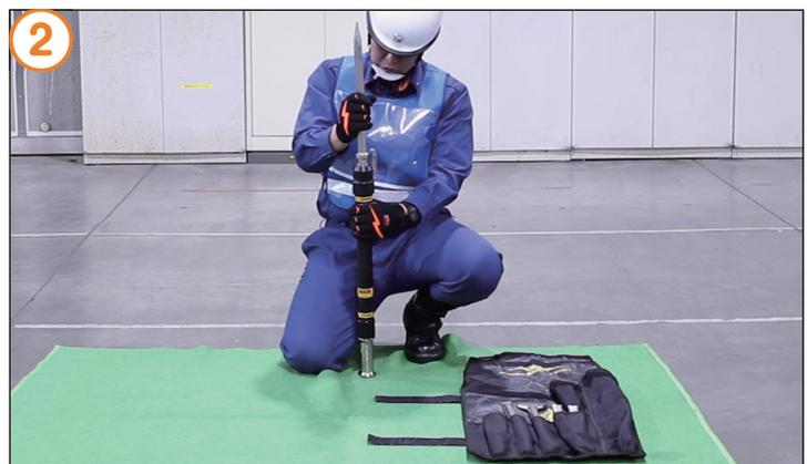
③リティナーロックリングを締め、先端工具が抜け落ちないように確実に固定します。リティナーロックリングを締めていくと、リティナーフィンガーが先端工具に掛かり、脱落を防止します。
