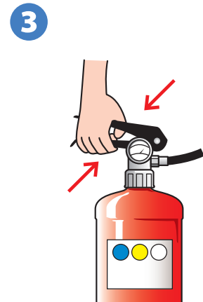
上のレバーと下のレバーをいっしょに強くにぎると、消火剤が放出される。
