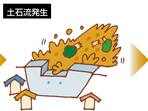
土石流をくい止め人家を守る
