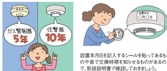
※ガス警報器には「都市ガス警報器」、「LPガス警報器」「CO（一酸化炭素）警報器」、「住宅用火災・CO警報器」、「住宅用火災・ガス・CO警報器」があります。
