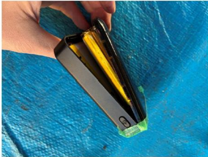
膨張したリチウムイオン電池
