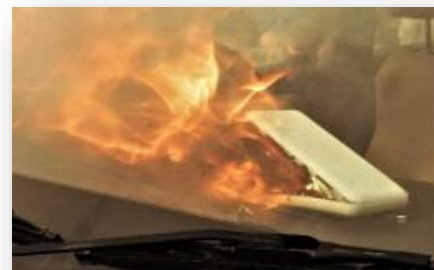
自動車内で発火するモバイルバッテリー 【NITEの再現実験】
