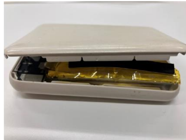
膨張したリチウムイオン電池
