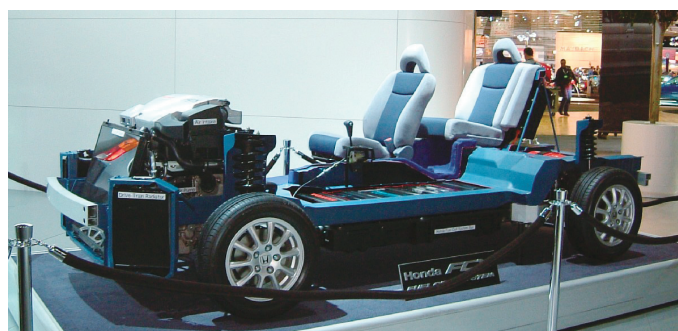
写真2-1 燃料電池自動車の仕組み
