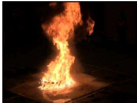
薄層ボイルオーバー発生
