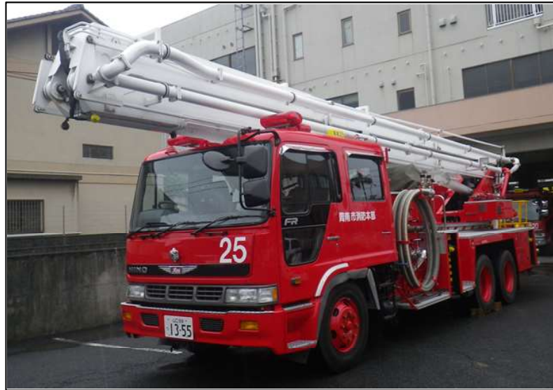
写真7-1-2 大型高所放水車
