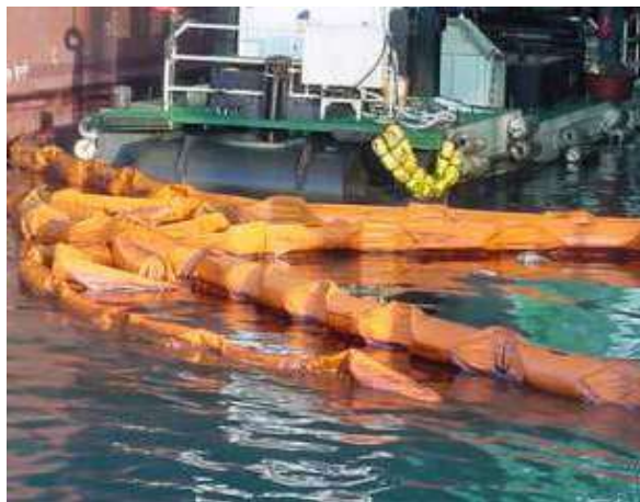
写真8-8-1 キシレンで溶けたオイルフェンス
