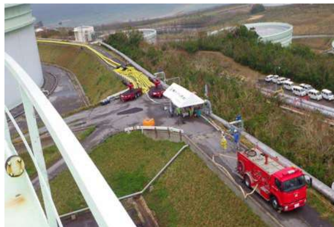
写真10-4-3 大容量泡放射システムの配置状況
