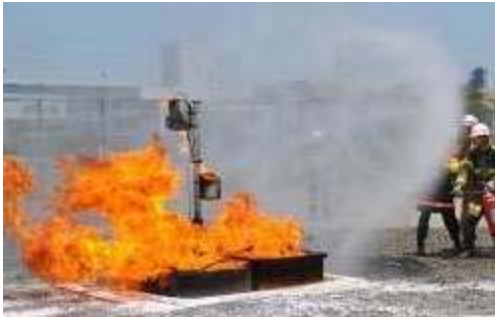
写真2-3-15 水霧による火災の制御
