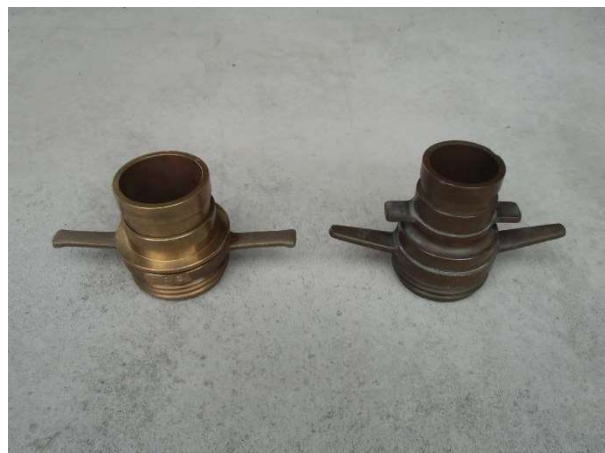
写真7-9-2 媒介金具（左側が75mm、右側が65mm）
