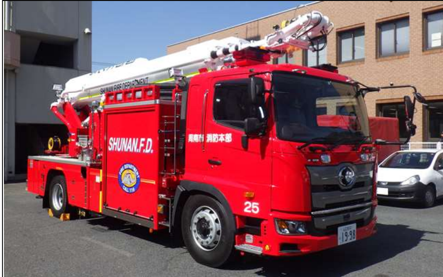
写真7-1-4 大型化学高所放水車
