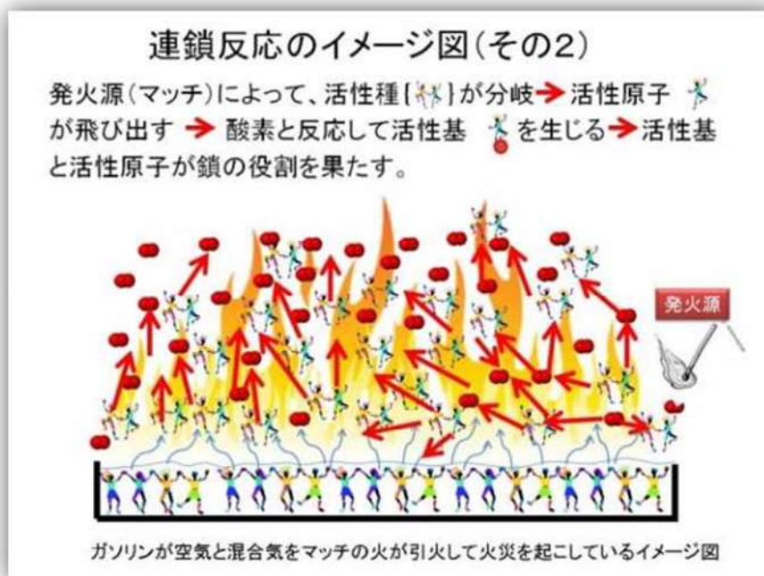
図2-1-3 発火源によって連鎖反応が開始、継続したイメージ図
