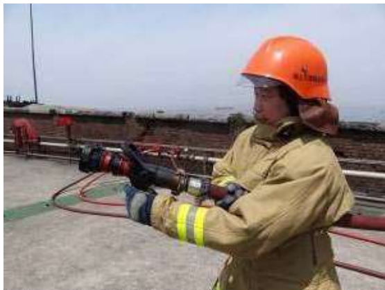
写真2-2-10 アクロンノズル(ガングリップ付ノズル)を 把持するノズルマン
