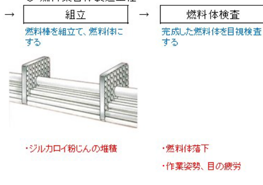
[図Ⅱ-14-12 核燃料加工フローと主な潜在危険性(ハザード)(工程詳細)]
