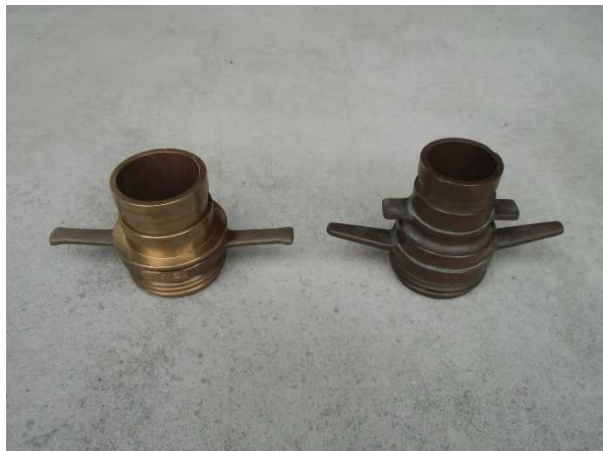
写真7-9-2 媒介金具（左側が75mm、右側が65mm）
