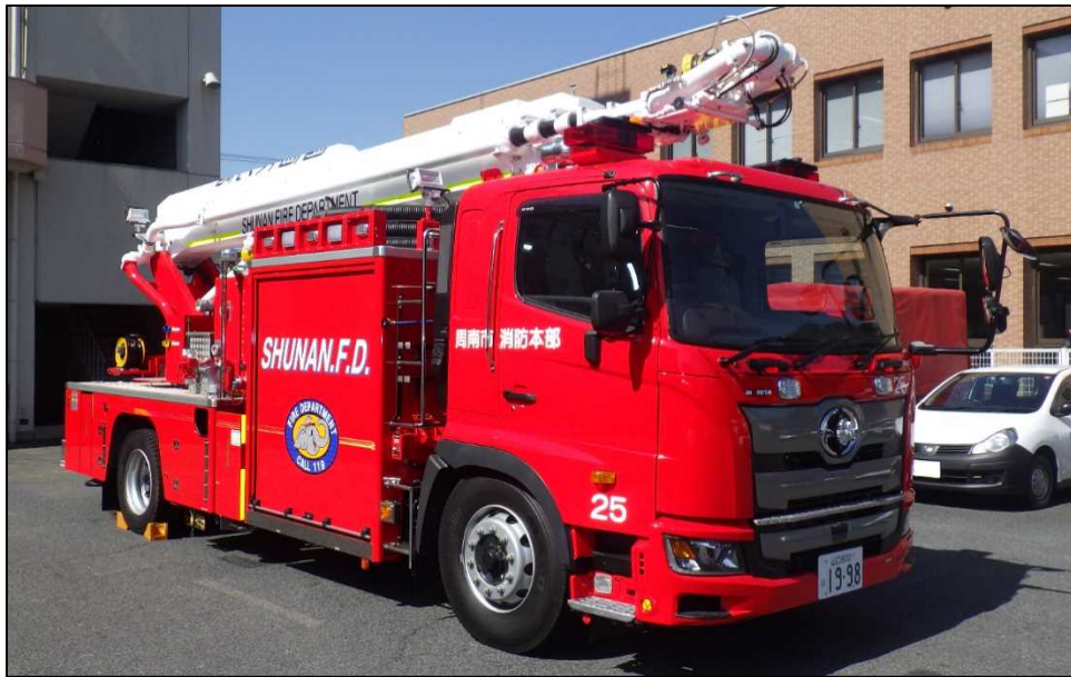
写真 7－1－4 大型化学高所放水車
