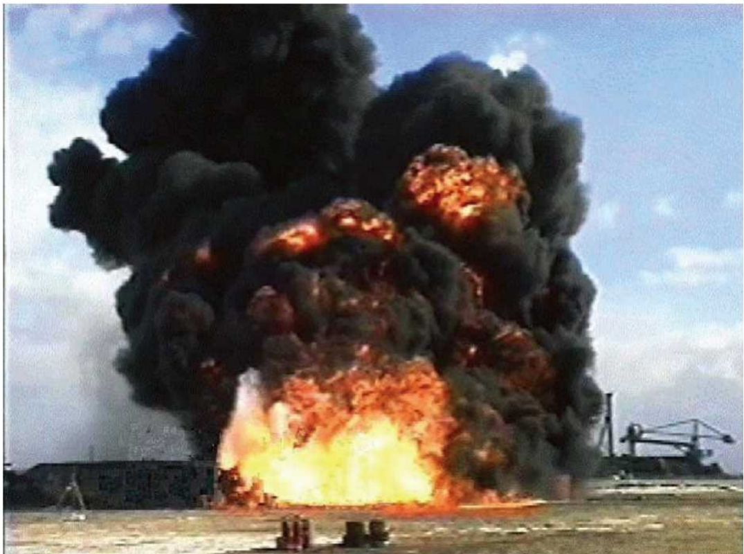
写真 2-2-1 直径 5 メートルの容器を用いたボイルオーバーの実験
