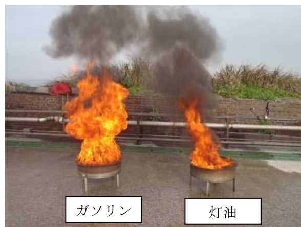
写真2-1-5 ガソリンと灯油の水(水霧)による消火比較
