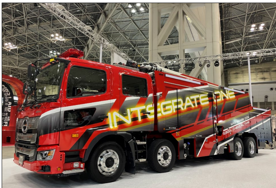
写真 7－1－5 消火薬剤タンク付き大型化学高所放水車 （株式会社モリタ提供）
