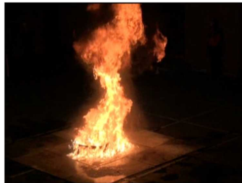
薄層ボイルオーバー発生
