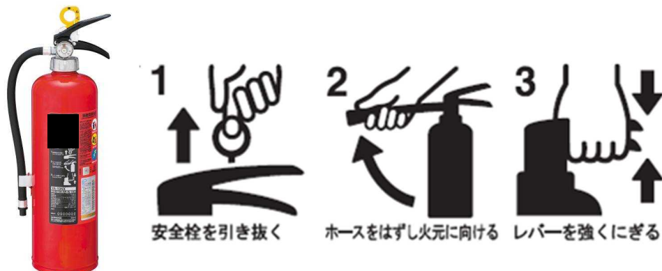
図 7－8－1 第 5 種の消火設備（粉末消火器の場合）
