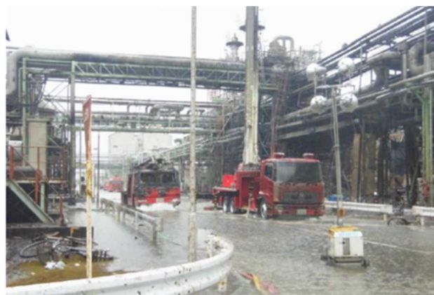
写真 10-2-4 焼損した消防用自動車
