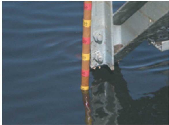
写真 10-3-6 定点観測用手作りスケール
