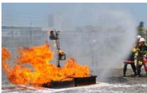
写真2-3-15 水霧による火災の制御
