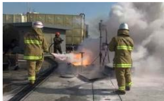
写真2-3-11 三次元及び平面火災への放射
