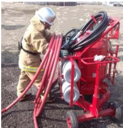
写真2-2-32 立てた状態で充水
